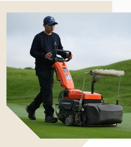
**COMPATIBLE WITH ALL** VIRTUALLY SILENT VERTICUTTING **CAPABILITIES** CUTTING **ECLIPSE 2 ACCESSORIES CUT HEIGHT BLADES PER REEL CUT WIDTH MOWER POWER 1877 2211** 0.062"-SAMSUNG **50AH** OR 26" 0.438''(45.7CM, 55.9CM OR 66CM) **LITHIUM BATTERY** (1.57MM - 11.13MM) **AVAII ARI F** COF
